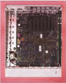
Tutto l'interuttore, tenuto da un aggancio a scatto, si può smontare l'eleganza della pancia madre, anche il filo e quello che collega l'altoparlante esterno. Negli USA la pancia madre viene venduta da sola come upgrade dell'Apple IIe.
